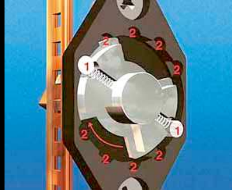
Lorsque vous tournez la poignée, les goupilles de sécurité (1) montées sur ressort s'engagent dans des évidements spéciaux prévus dans le logement (2) et produisent alors le cliquetis typique de la poignée Secustik®, le plus « sécurité » qui s'entend.
